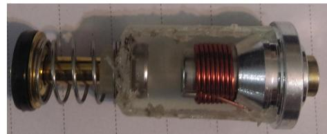
اگر قطعه ترمودینامیکی را به قطعه الکترومغناطیسی دستگاه وصل کنیم در این حالت اگر فنر را به سمت پایین فشرده کنیم فنر بر می‌گردد و پیستون پایین نمی‌ماند. اگر انتهای قطعه ترمودینامیکی را روی حرارت گرفته و گرم کنیم مشاهده می‌کنیم؛ اگر پیستون را به سمت پایین فشار دهیم، همانجا باقی می‌ماند.
